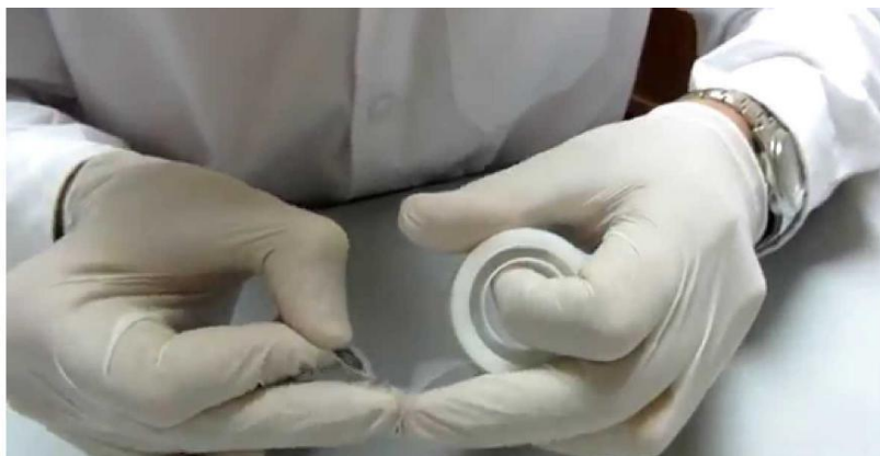
Рис.1.2 Физический способ получения графена из графита расслаивания.
