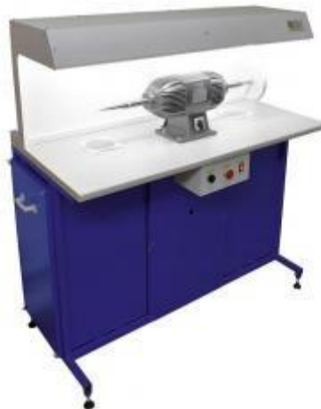
Рисунок 4. – Полировальный станок мод. Ю-800
