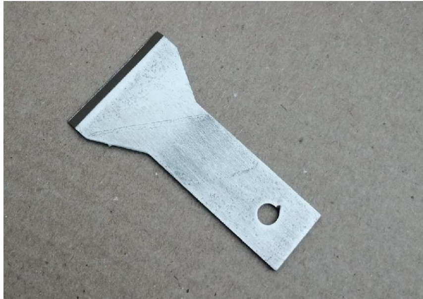
Рисунок 5. – Роторный нож для дробления пластика
