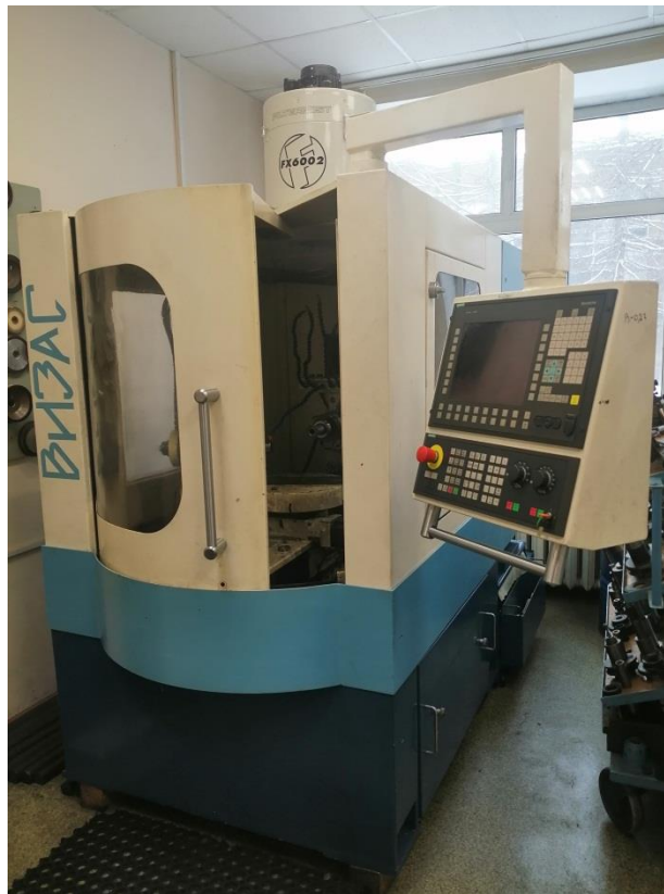
Рисунок 1. Шлифовально-заточной станок с ЧПУ ВИЗАС ВЗ-740Ф4(1)
