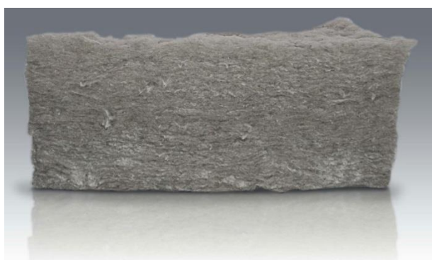
Рисунок 7. Структура КМ – органоволокнита
