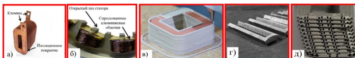
Рисунок 2. Примеры обмоток АП: а) и б) профилированная обмотка [10], в) обмотки со встроенной керамической изоляцией [11], г) алюминиевые обмотки с УНТ [12], д) обмотки со встроенными каналами жидкостного охлаждения [13]
