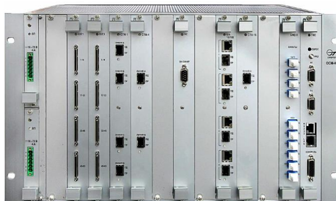
Рисунок 1. Оборудование синхронного мультиплексирования комбинированное ОСМ-К
