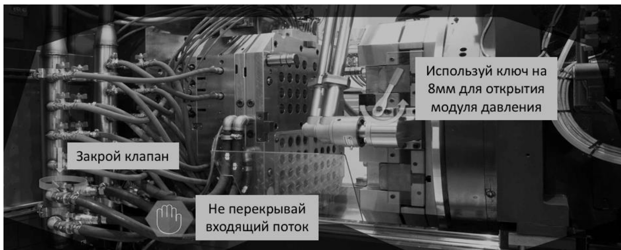
Рисунок 1. Обзор глазами оператора во время процесса ремонта
