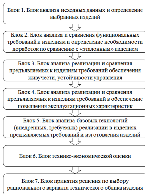
Рис. 1. Поблочная схема обоснования вариантов рационального технического облика изделия
