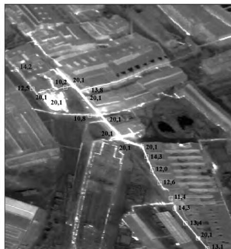
Рис. 2. Пример определения температуры поверхности над теплотрассой.
