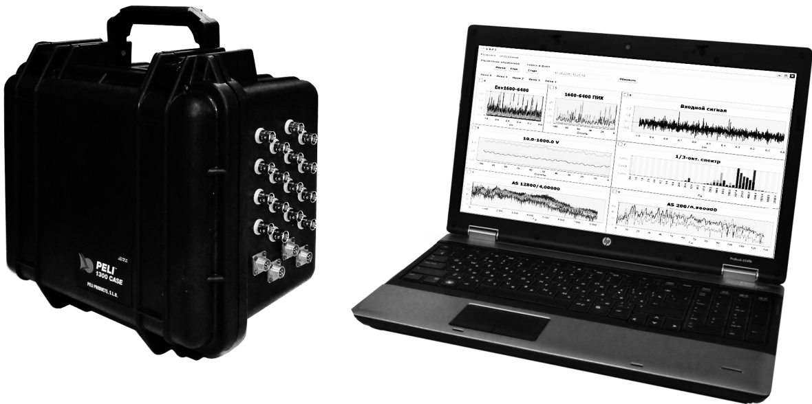
Рис.2. Мобильная система мониторинга и диагностики СМД-4, используемая в режиме предварительной записи сигналов вибрации, тока и частоты вращения с их последующим анализом.
