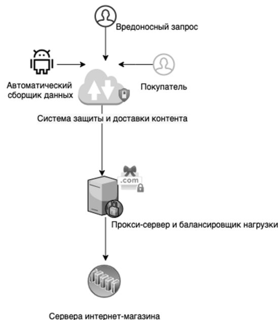
Рис.1. Схема взаимодействия сервера Internet-магазина, системы доставки контента и реверсивного прокси-сервера.
