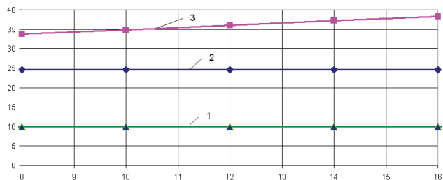
Рис. 2. Влияние плотности перфорации металлокаркаса на эффективный коэффициент теплопроводности МГТИ [Вт/(мК)].
