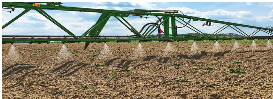
Рис. 2. Ленточное опрыскивание по рядкам с AmaSelect Row
