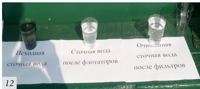
Фото12. Результаты очистки сточных вод
