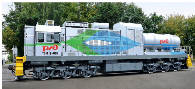
Фото 2. Маневровый газопоршневой тепловоз
