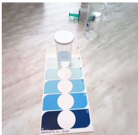
Рис. 4. Цветовая шкала для определения уровня фосфатов
