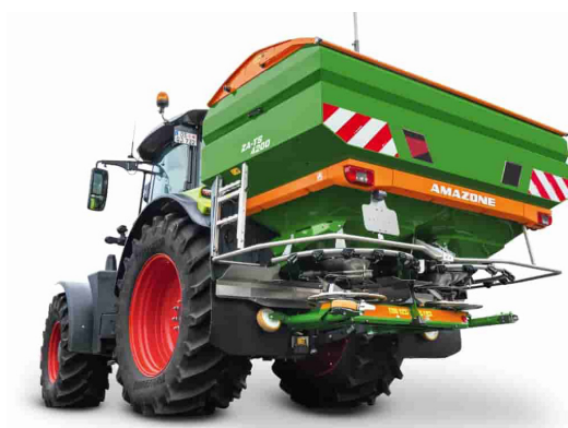
Рис. 2: а-разбрасыватель для дифференцированного внесения удобрений ZA-TS; б-система ArgusTwin для контроля и управления
