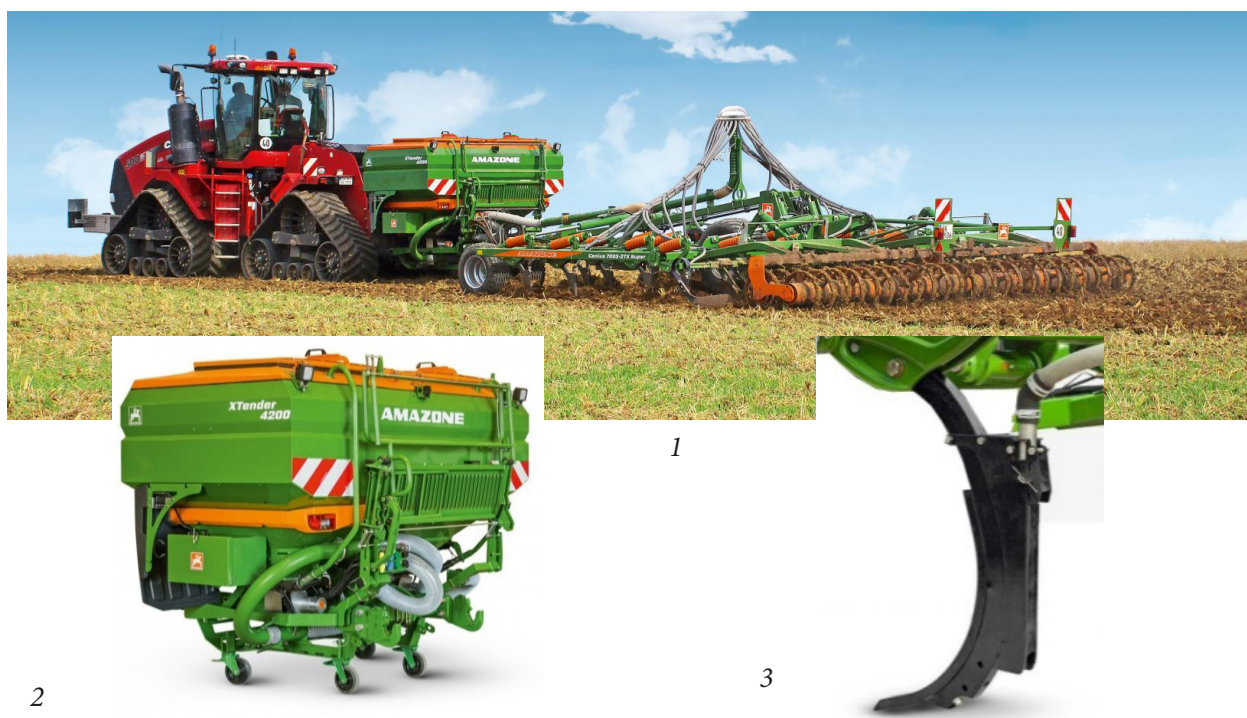
Рис. 3: 1-комбинированный агрегат компании «AMAZONEN-Werke» для внутрипочвенного внесения удобрений; 2-большеемобъемный бункер Xtender; 3-рабочий орган культиватора Senius
