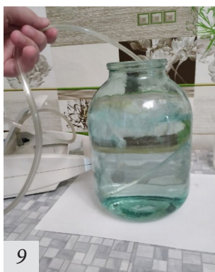
Фото 8. Результат опыта № 1. Флотация — мазут всплыл на поверхность
