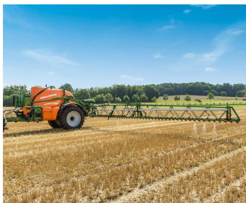
Рис. 1. Прицепной опрыскиватель UX АmaSpot с интеллектуальной системой сенсорных форсунок
