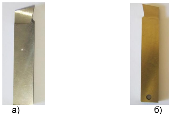
Рисунок 1 - Внешний вид резцов после нанесения покрытий. а- исходный резец, б-резец с покрытием ZrCN
