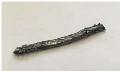
Рис. 1. Внешний вид сорбента на основе графена.
