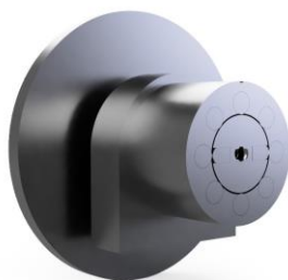
Рисунок 3 – РКМ с измененным ковочным узлом.
