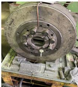
Рисунок 1 – Размещение резистивного датчика давления внутри РКМ
