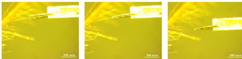
Рисунок 1 – Манипулирование сенсиллой сверчка Phaeophilacris bredoides с помощью микропинцета.
