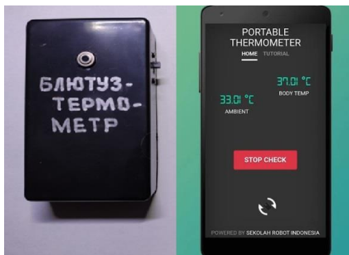
Рис. 1. Макет устройства для измерения температуры тела
