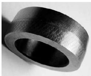
Рис. 1. Деформирующий элемент для дорнования отверстий по патенту РФ № 2560477 с РМР поверхности и износостойким покрытием.
