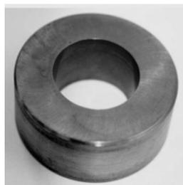
Рис. 2. Деформирующая фильера с РМР поверхности рабочего канала, полностью покрытая «сервовитной» плёнкой после волочения в среде металлоплакирующей смазки (патент РФ №2647057).
