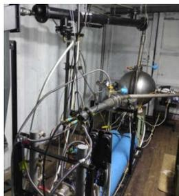
Рис. 2. Фото установки для газификации органических отходов, смонтированной в 20-футовом морском контейнере (до 100 кг/час лигнина, опилок, отходов кофейных машин, ВУС).
