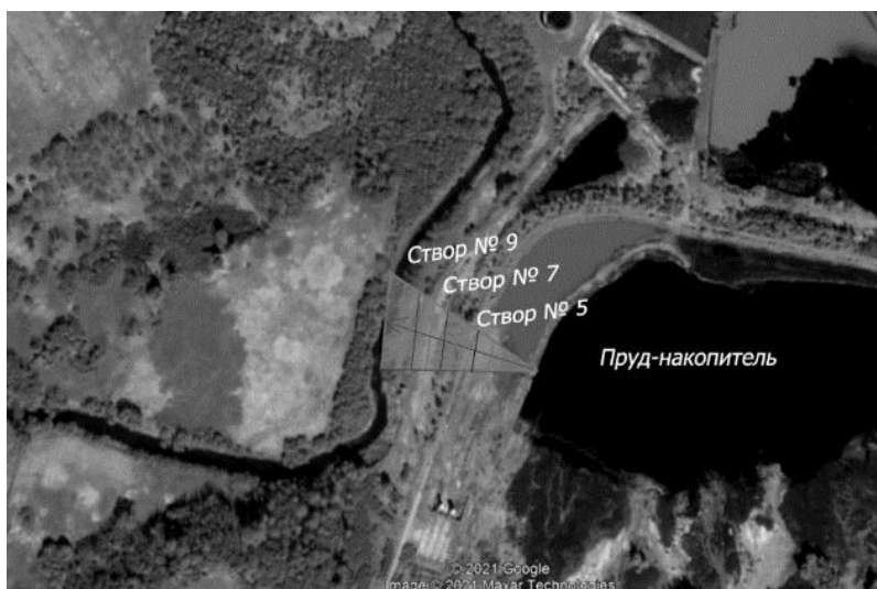
Зона затопления при аварийном разрушении дамбы пруда-накопителя
