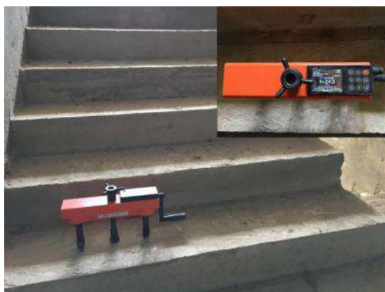
Рис. 2. Использование механических приборов определения прочности.
