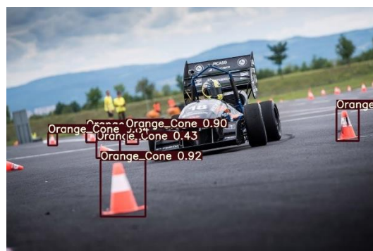
Рисунок 2 – Визуализация работы обученной YOLOv3
