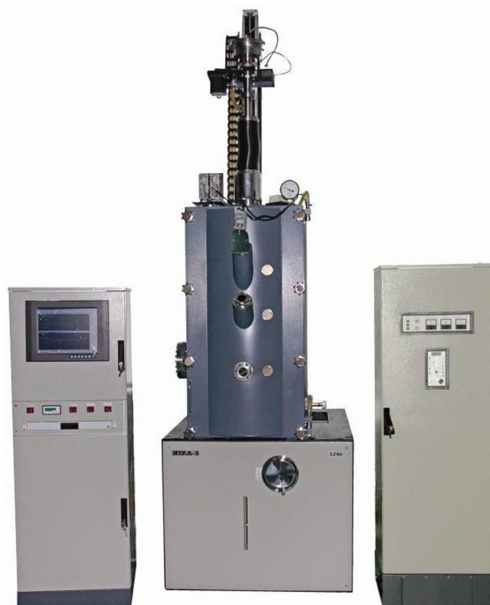
Рисунок 1 Установка для выращивания кристаллов методом Чохральского
