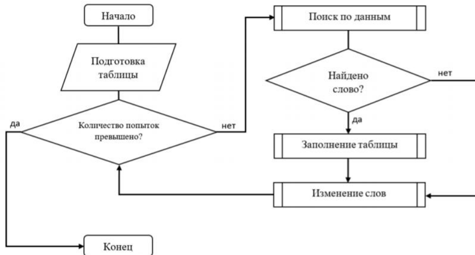
Рисунок 2 – Блок-схема алгоритма поиска на зашифрованных данных с изменением ключевых
