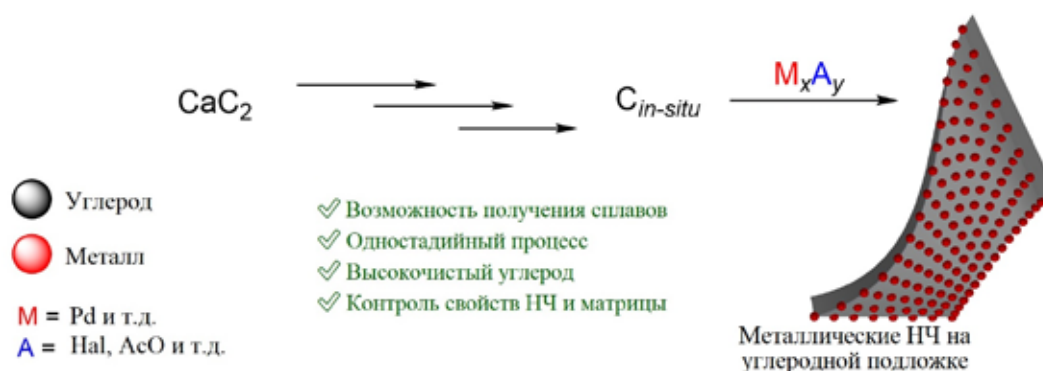
Схема 1. Получение НЧ металлов и сплавов на углеродной подложке.
