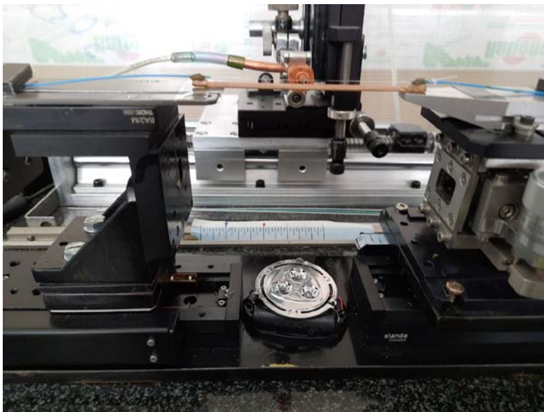
Рис. 1. Установка по вытягиванию волокна методом нагрева.
