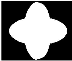
Рис. 3. Изображение в отклике АДЭГ при \nabla E_1 = \nabla E_2 = \nabla E_3 = \nabla E = 0 , \Delta\phi_1 = 0 , \Delta\phi_2 = 0
