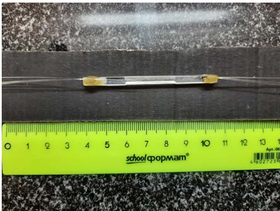
Рис. 2. Полученное волоконно оптическое устройство – массив волокон 4в4
