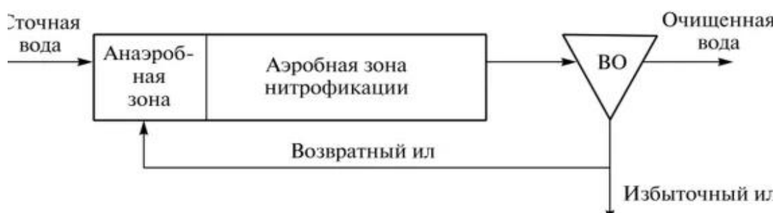
Рисунок 1. Принципиальная схема А/О (анаэробно-оксидного) процесса удаления азота и фосфора
