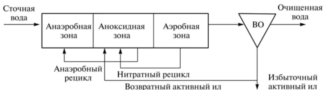
Рисунок 3. Принципиальная схема процесса UCT
