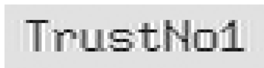
Рисунок 2 – Тот же самый текст, но после прохождения через фильтр низких частот
