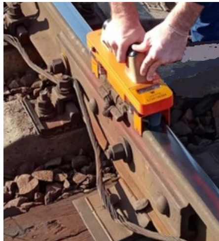
Рисунок 1. Измерение переходного сопротивления сборного токопроводящего рельсового стыка
