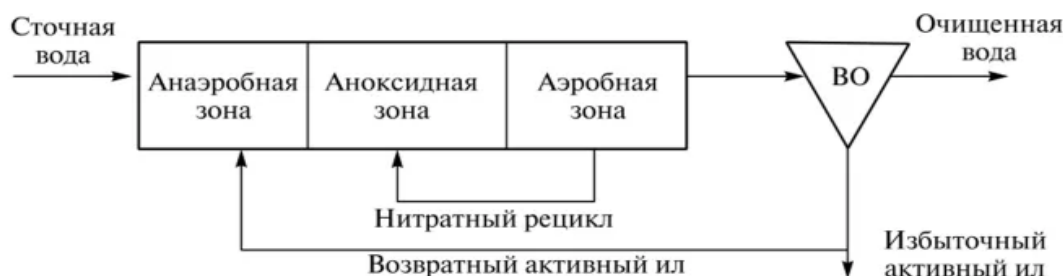
Рисунок 2. Принципиальная схема А2/О процесса удаления азота и фосфора
