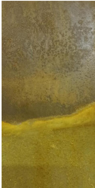
Рис. 5. Результат взаимодействия кислой среды на покрытие «ЦИНОФЕРР» после 10 дней
