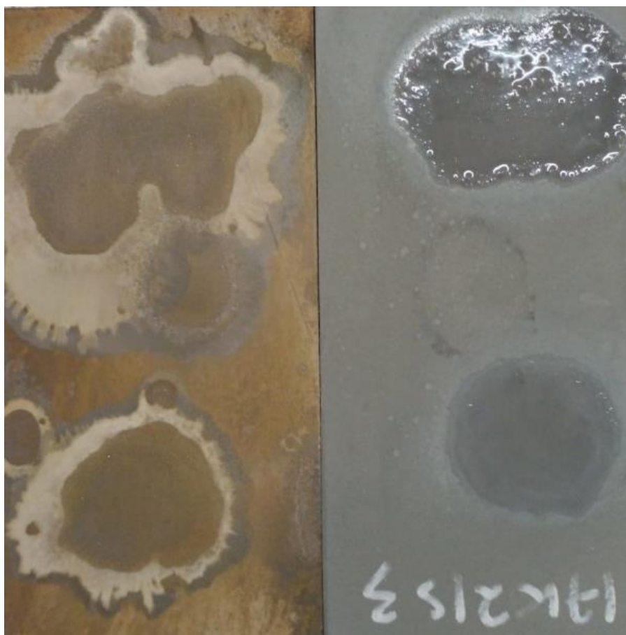
Рис. 1. Последствия воздействия соляной кислоты (HCl) на стальные пластинки. Слева – без защитного покрытия. Справа – с использованием защитного покрытия «ЦИНОФЕРР»
