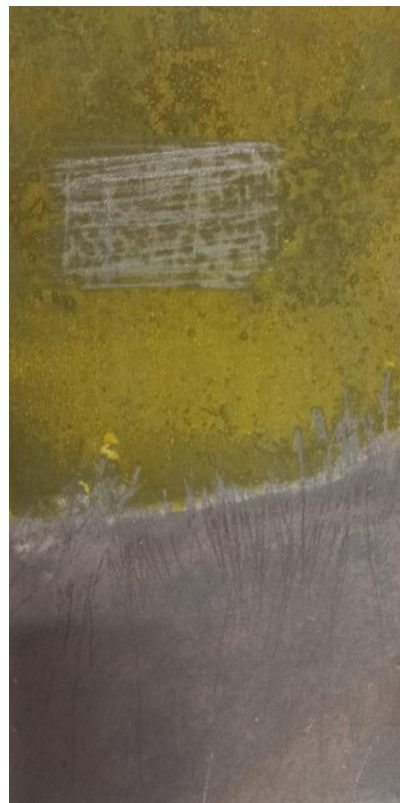
Рис. 6. Пластина после механического удаления солей с покрытия «ЦИНОФЕРР»
