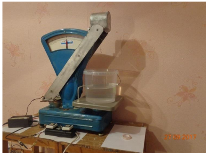
Рис. 2. Устройство для измерения объёма тел любой формы
