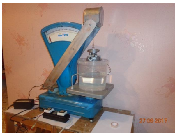
Рис. 3. Устройство подготовлено для измерения объёма тела (детали)
