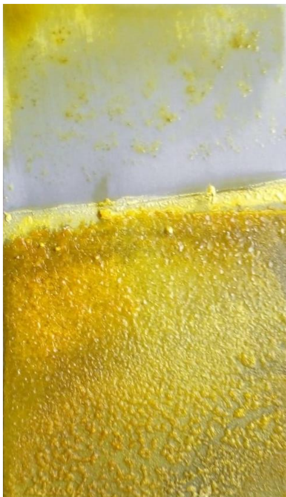
Рис. 4. Результат взаимодействия кислой среды и покрытия «ЦИНОФЕРР» после 4 дней
