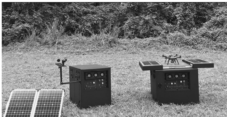
Рисунок 2 – Автономная зарядная станция Dronebox с дронами
