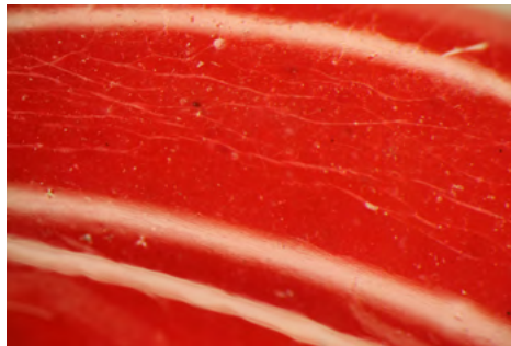
Ил. 7. Сургучная печать, обработанная париленом, толщина покрытия 30–40 мкм: а) до нагружения, \times 15 ; б) до нагружения, \times 48 ; в) образец, после нагружения 25 кг, \times 94,5
