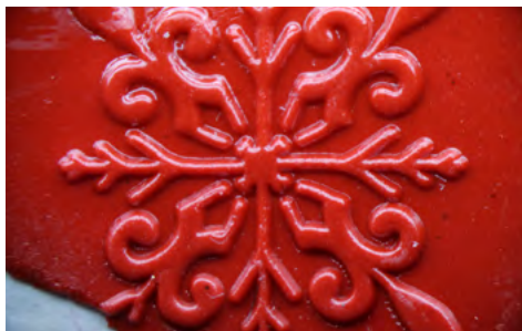
Ил. 8. Сургучная печать, обработанная париленом, толщина покрытия 50 мкм: а) до нагружения, \times 15 ; б) до нагружения, \times 60 ; в) образец, после нагружения 25 кг, \times 94,5
