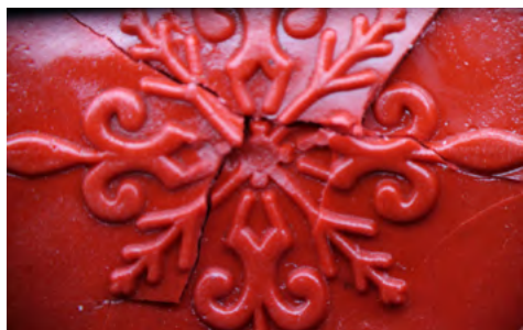
Ил. 8. Сургучная печать, обработанная париленом, толщина покрытия 50 мкм: а) до нагружения, \times 15 ; б) до нагружения, \times 60 ; в) образец, после нагружения 25 кг, \times 94,5
