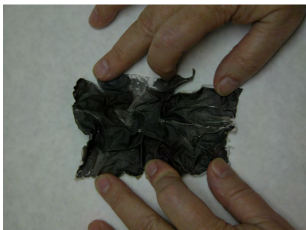
Ил. 4. Образец обугленной бумаги, обработанной париленом, толщина покрытия 10–15 мкм
