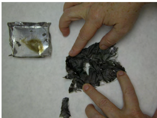
Ил. 3. Образец обугленной бумаги, обработанной париленом, толщина покрытия 30–35 мкм
