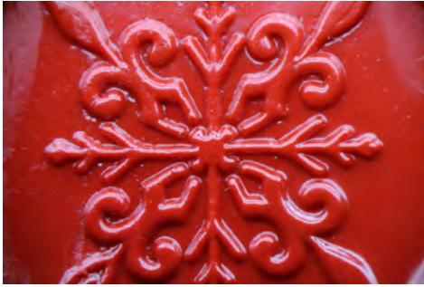
Ил. 6. Сургучная печать, обработанная париленом, толщина покрытия 15–20 мкм: а) после нагружения 10 кг, \times 15 ; б) после нагружения 25 кг, \times 24
