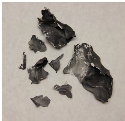
Ил. 5. Образец обугленной бумаги, обработанной париленом, толщина покрытия менее 5 мкм
