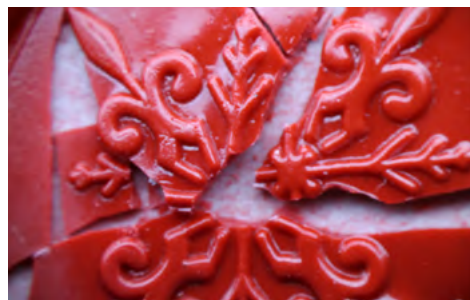
Ил. 8. Сургучная печать, обработанная париленом, толщина покрытия 50 мкм: а) до нагружения, \times 15 ; б) до нагружения, \times 60 ; в) образец, после нагружения 25 кг, \times 94,5
