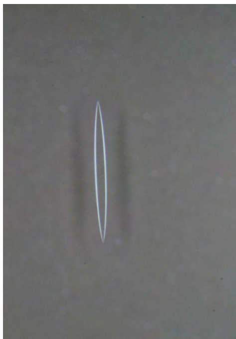
Ил. 3. Пузыри в стекле негативов: а) единственный вытянутый (веретёнообразный пузырь); б) вуаль из мошек и веретёнообразных пузырей
