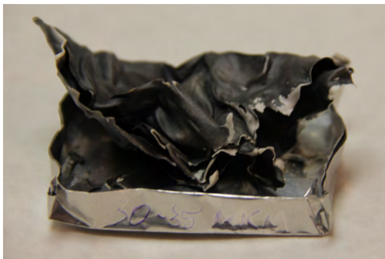
Ил. 2. Образец бумаги скомканный, сожженный на металлической кювете и вместе с ней обработанный париленом
