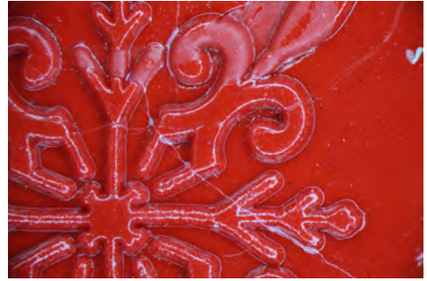
Ил. 6. Сургучная печать, обработанная париленом, толщина покрытия 15–20 мкм: а) после нагружения 10 кг, \times 15 ; б) после нагружения 25 кг, \times 24
