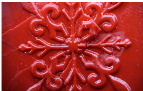
Ил. 9. Сургучная печать, сломанная и обработанная париленом, \times 15 : а) толщина покрытия 15–20 мкм; б) толщина покрытия 30–40 мкм; в) толщина покрытия 50 мкм
