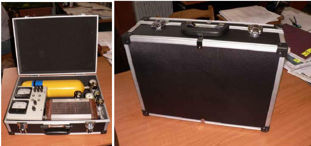
Рисунок 5. Робочий зразок металогідридної станції водневого енергозабезпечення.
