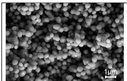
Микрофотографии частиц 2-ПAM+ГИЗ-16@МСМ, полученные на сканирующем электронном микроскопе
