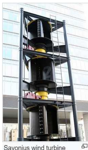
Рис. 1. Ветряная турбина Савониуса
