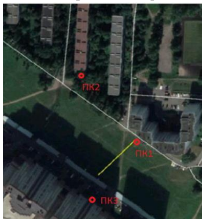
Рис.3. Положения дополнительных измерительных пикетов при магнитометрических оценках воздействия ЛЭП
