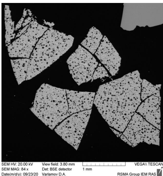
Рис.2. Равномерное распределение глобулей по стеклу в обр.1. Изображение в обратно-рассеянных электронах.
