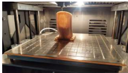
Рис. 1. Термостатичная камера принтера 3DLIFE THERMO
