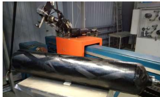
Рисунок 2. Общий виде полимер-композитного баллона (тип IV)
