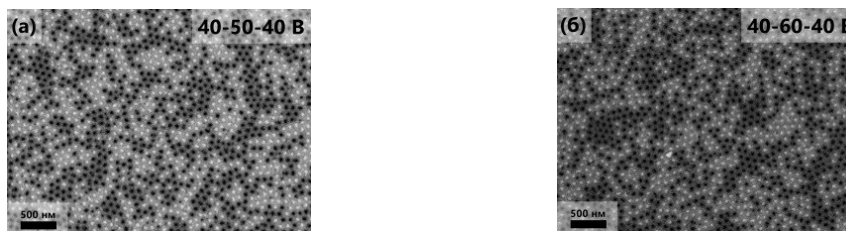
Рис. 1. РЭМ-изображения поверхности наноконпозитов Au/АОА на основе матриц, полученных при увеличении напряжения анодирования до 50 В (а) и 60 В (б).
