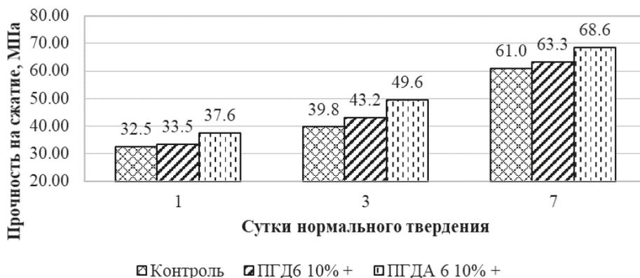
Рис. 2. Прочность образцов из цементной пасты
