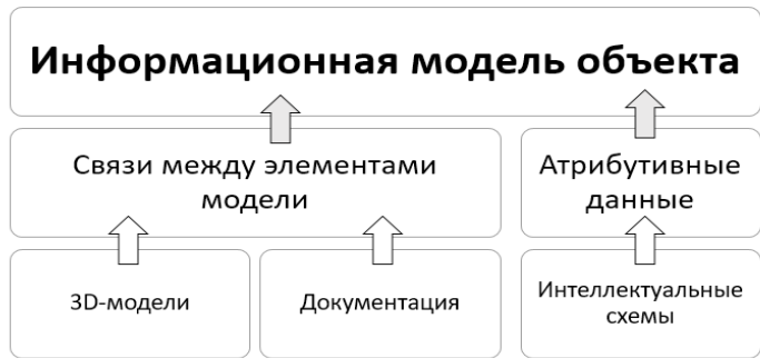
Рис. 1. Концептуальная схема состава элементов информационной цифровой модели
