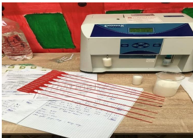
Рисунок 1 – Анализатор молока «EkoMilk Total 90 s».
