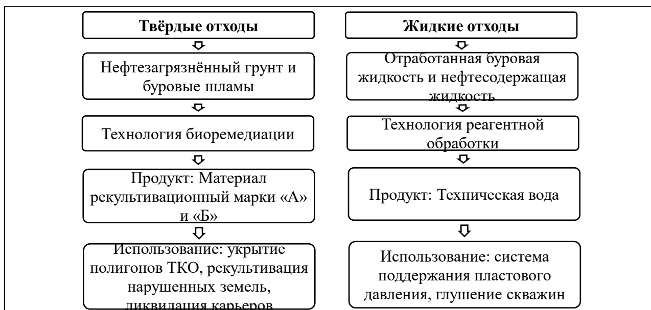
Рис. 2. Схема обработки и утилизации нефтесодержащих и буровых отходов с получением товарных продуктов [10]
