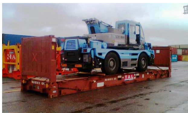
Рис. 2. Размещение тяжелой техники на flat rack-контейнере
