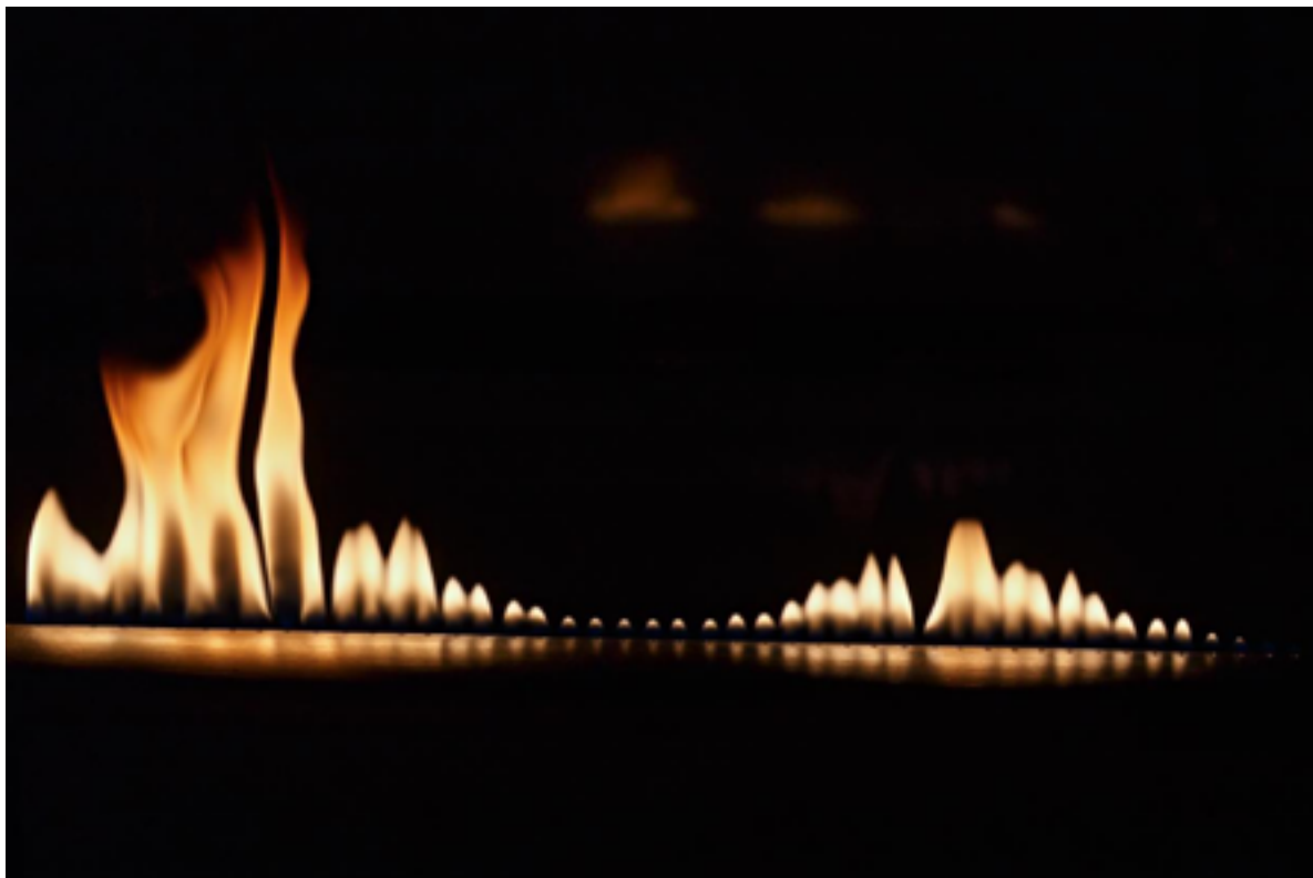
Рис.7. Стоячая волна при частоте \approx 450 Гц
