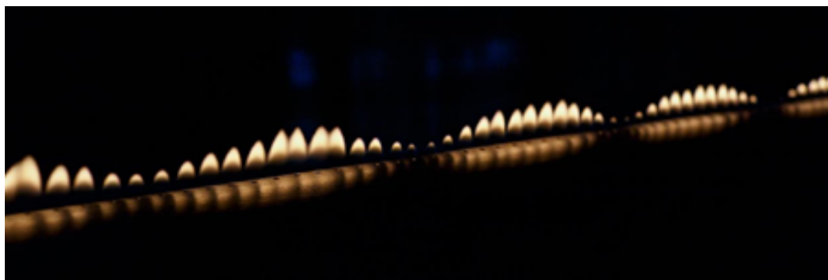
Рис.6. Стоячая волна при частоте \approx 1100 Гц
