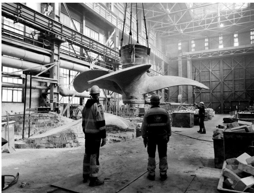
Рисунок 2. Извлечение отливки винта из формы
