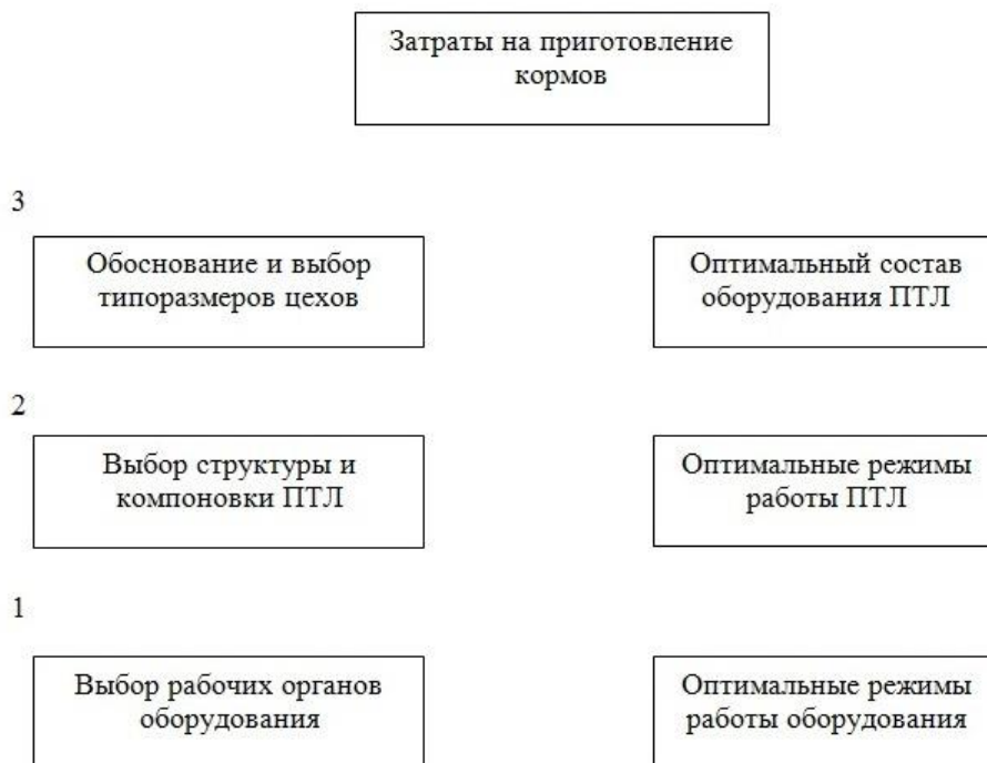
Рисунок 1. Уровни моделирования технологического процесса переработки мясокостных отходов звероводства и птицеводства в сухие животные корма
