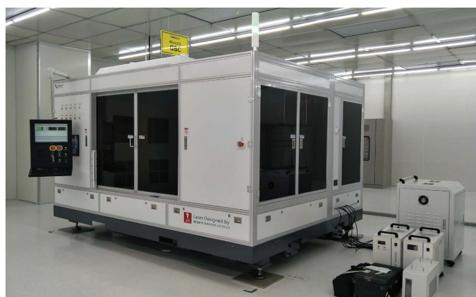
Рис. 1. Блок-схема и фотография установки для резки жидкокристаллических дисплеев
