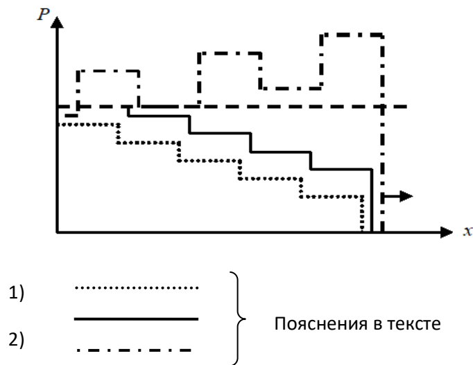
Рисунок. 2. Профиль ударной волны в преграде при различных соотношениях жесткостей ударника, панели бронезишета и преграды.
