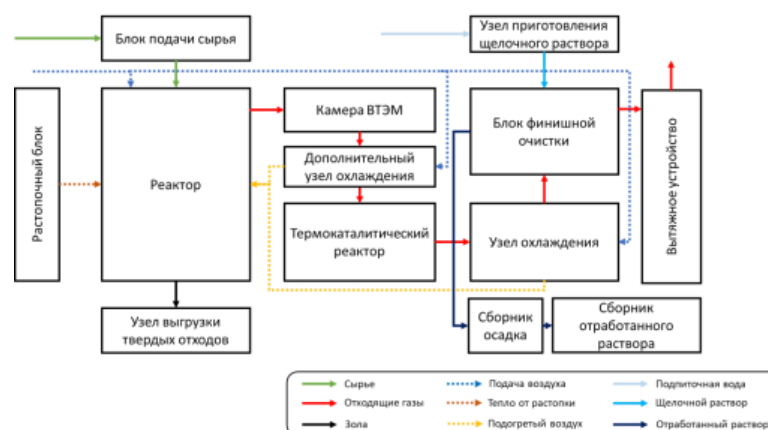
Рис. 7. Модифицированная принципиальная схема термовихревого деструктора.
