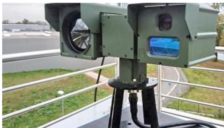
Рис.2. Тепловизионная мультисенсорная система ПЕРГАМ РТР-225М.
