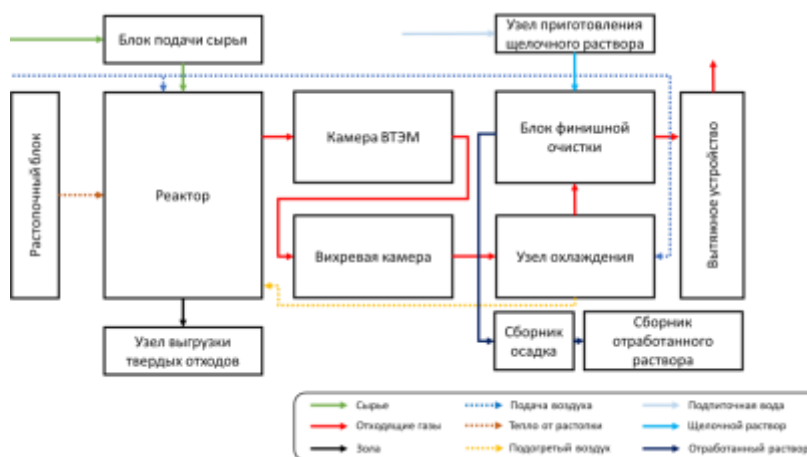
Рис. 1. Принципиальная схема ТВД.
