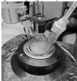
Рис. 1. Колба с коллоидным раствором композитов AIS/ \text{TiO}_2 на конечной стадии синтеза
