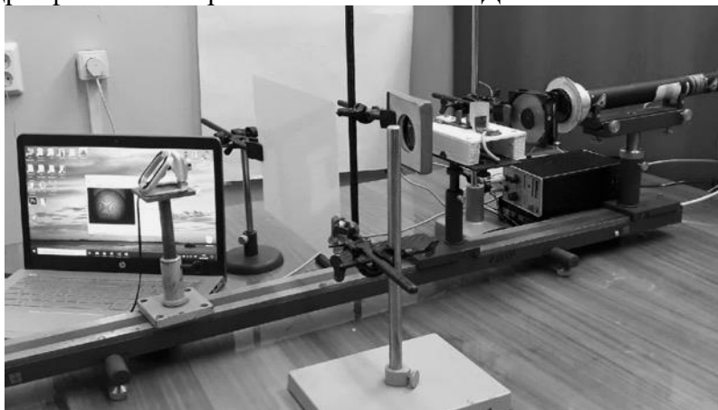
Рис. 3. Фотография лабораторного образца прибора для определения электрооптических коэффициентов кристаллов класса 3m
