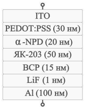
Рис. 1. Схематическое изображение расположения слоев в OLED- структуре
