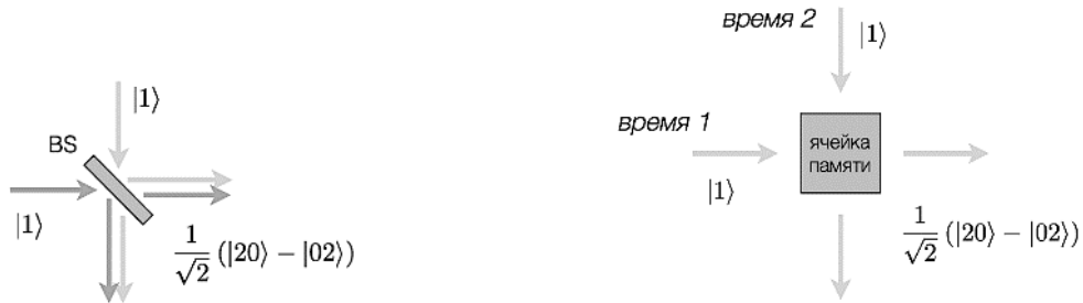
Рис. 1. Эффект Хонга-У-Манделя с помощью полупрозрачной пластины
