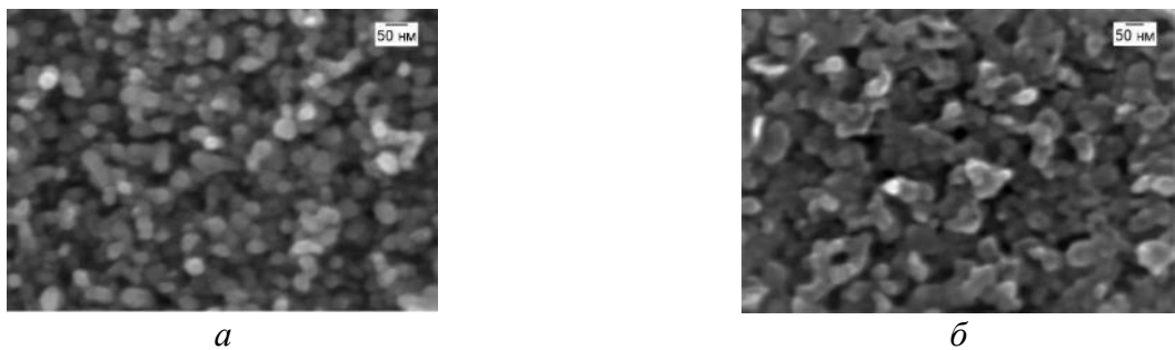
Рис. 1. Микрофотографии слоя Zn с исходной толщиной 80 нм до (а) и после термоокисления (б)
