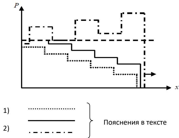
Рисунок. 2. Профиль ударной волны в преграде при различных соотношениях жесткостей ударника, панели бронезилета и преграды.
