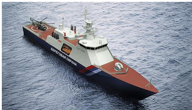
Рисунок 3. Патрульный корабль проект 22100 класса Arc 4, оснащенный АУ АК -176 (ОАО «ЦМКБ «Алмаз», ОАО «Зеленодольский завод имени А.М. Горького»)
