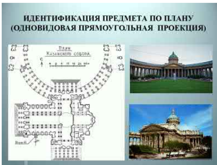
Рис. 4. Пример идентификации предмета по одновидовой прямоугольной проекции
