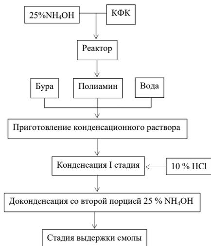
Рис. 2. Стадии получения смолы на основе  $\text{NH}_4\text{OH}$  и КФК
