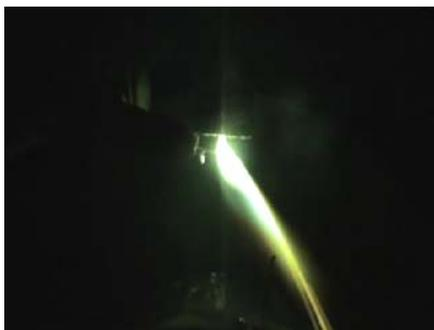
Рис. 5. Плавнение присадочной проволоки в отсутствии детали
