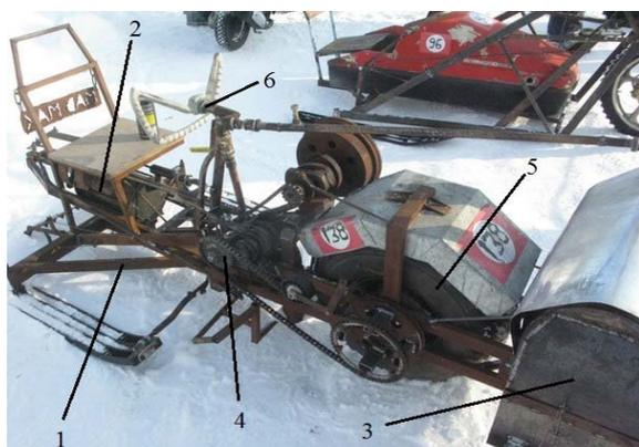
Рис. 1. Транспортное средство Унимото: 1 – рама; 2 – паровой двигатель; 3 – печь; 4 – трансмиссия; 5 – колесо; 6 – рулевое управление
