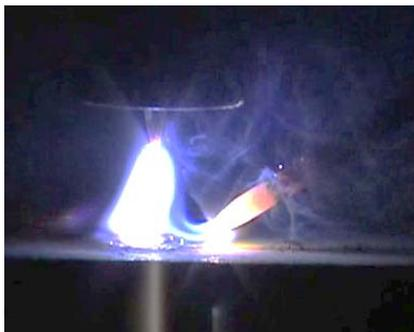
Рис. 1. Комбинация дуг с дугой косвенного действия  $W^- - W^+$
