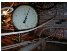
Рис. 3. Давление в начале гидравлических испытаний
