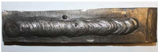
Рис. 1. Валик, наплавленный электродами ЦЛ–11
