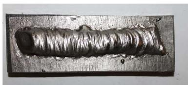
Рис. 2. Валик, наплавленный проволокой Св–06Х19Н9Т
