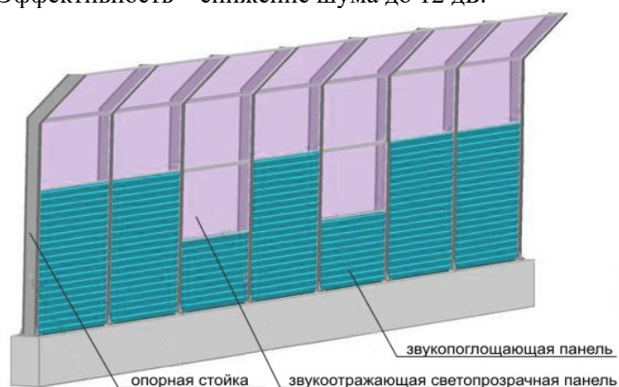
Рисунок 1 – Основные элементы шумозащитного экрана
