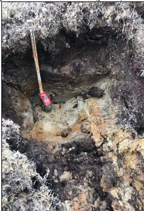
Рисунок 2 – Растепление мерзлых пород грунта и образование плывуна (фото автора)
