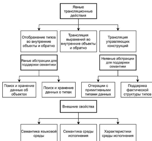
Рис. 1. Схема абстракций по принципу явности и неявности
