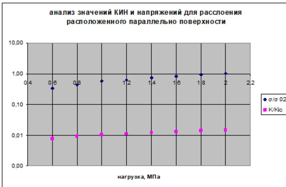
Рис. 1 Зависимость отношений значений КИН и эквивалентных напряжений в вершине расслоения к их критическим значениям от нагрузки
