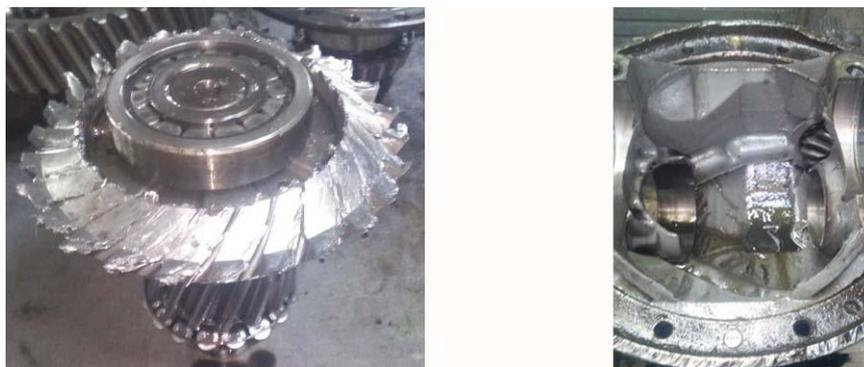
*Рисунок 1. Износ зубьев ведомого колеса Рисунок 2. Разрушение картера редуктора ведущего моста*
