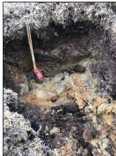
Рисунок 2. Растепление грунта и образование пльвуна (фото Лисенкова С.)
