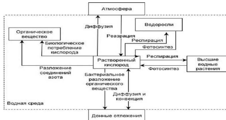
Рисунок 1. [3] – Основные процессы, влияющие на кислородный режим водотока
