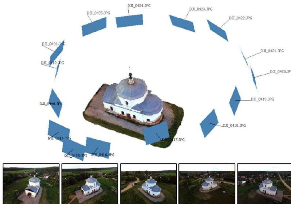
Рис. 3. Схема полёта БЛА относительно Храма.
