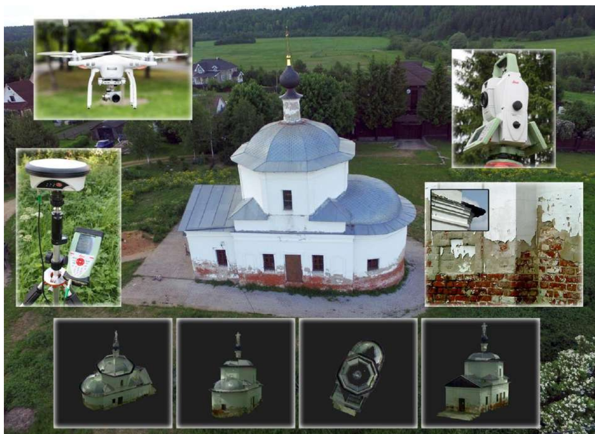
Рис. 4. Храм с высоты птичьего полёта. На врезках: БЛА «DJI Phantom -3», мобильный комплекс «Leica Viva», тахеометр «Leica Nova MS60», цифровые модели Храма.
