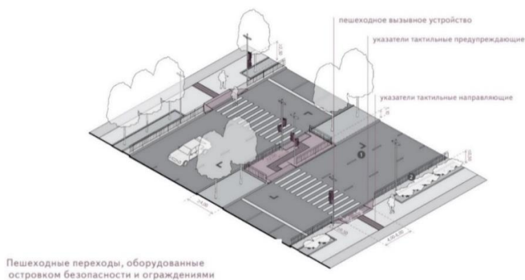
Рис.2. Пешеходный переход оборудован тактильными плитами для слабовидящих, ограждением, звука-сопровождающим светофором и осветительными приборами
