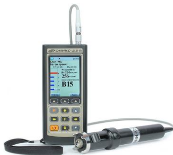
Рис. 1. Общий вид электронного склерометра «ОНИКС-2.5»
