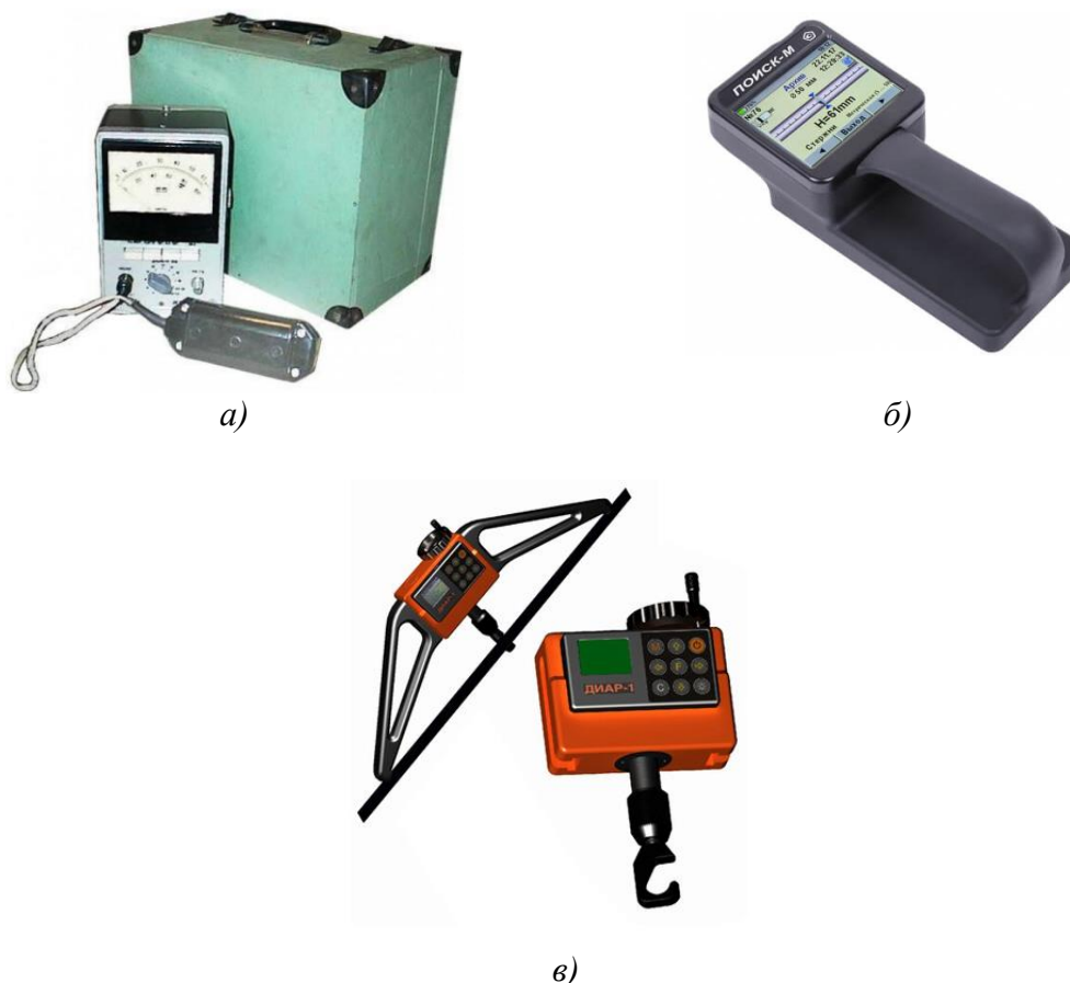
Рис. 2. Современные приборы, используемые в процессе контроля качества арматурных изделий: а) электромагнитный прибор, измеряющий толщину защитного слоя бетона ИЗС-10Н; б) электромагнитный искатель арматуры ПОИСК-М; в) измеритель силы натяжения арматуры ДИАР-1
