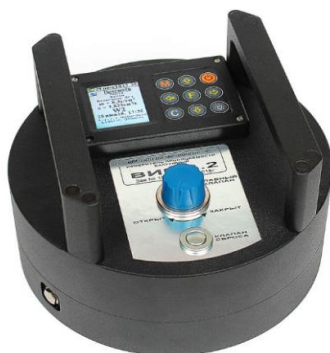
Рис. 6. Общий вид прибора измерения водонепроницаемости «ВИП-1.2»
