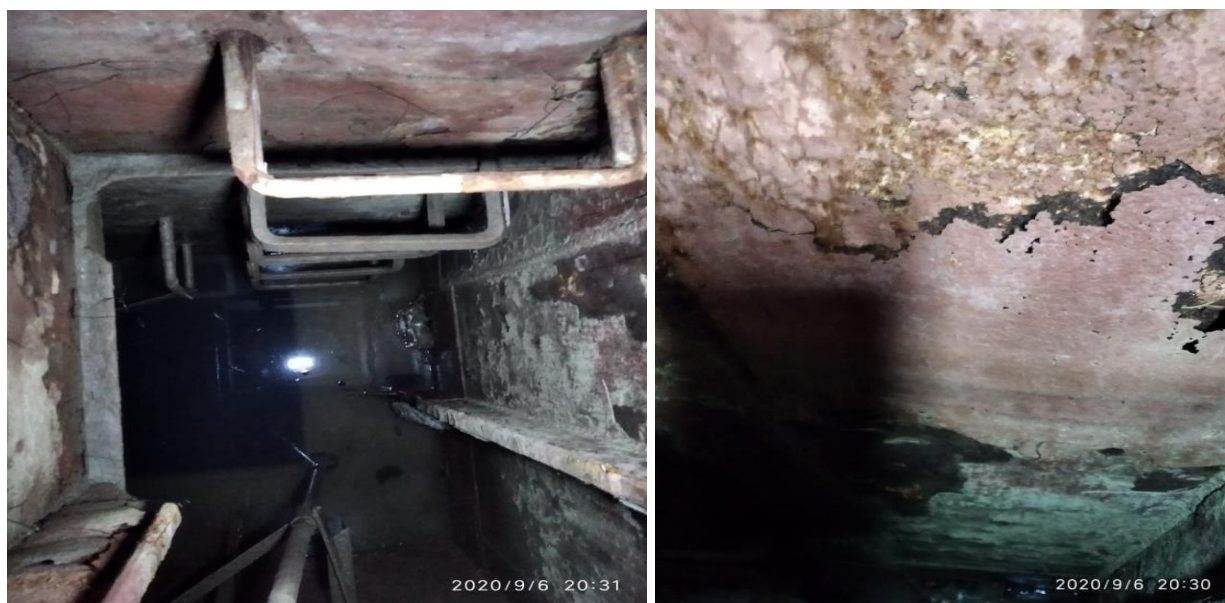
Рис. 5. Вид кингстонного ящика т/х «Волжский» после 1 года эксплуатации
