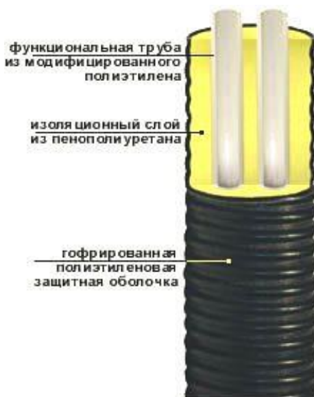
Рис. 2. Гибкий изолированный двойной трубопровод в защитном кожухе и пенополиуретановой изоляции
