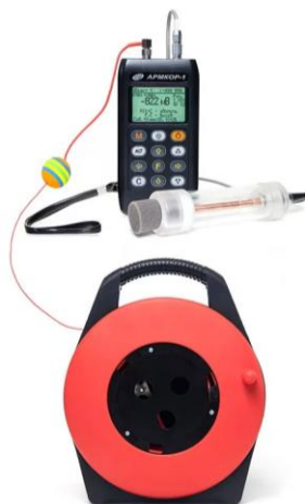
Рис. 7. Общий вид прибора оценки уровня коррозии арматуры «АРМКОР-1»
