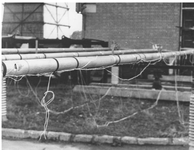
Рис. 2.8. Расположение тензодатчиков на поверхности шин.
