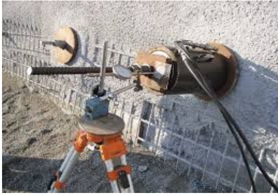
Рис. 4. Испытание на вырыв анкера из бетона: а) установка для испытания; б) анкерное устройство
