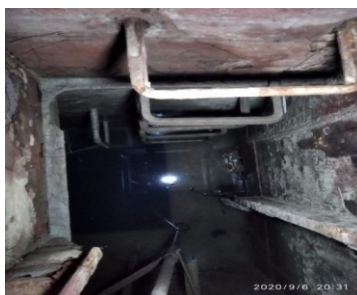
Рис. 1. Состояние кингстонного ящика после 1 года эксплуатации (т/х «Волморе»)
