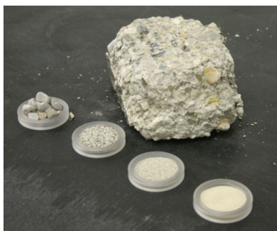
Рис. 1. Компоненты стандартного бетонного блока
