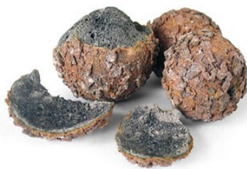
Рис. 6. Базовый наполнитель активного фильтра - керамзит
