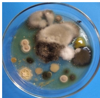
Рис. 1. Установление зон фунгицидности для компонентов ТРКШ 450 : а) без увеличения; б) с увеличением 2×8
